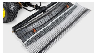
Finalizador de lâmina flexível de montagem traseira
