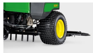
Acessório de dentes do escarificador com intervalos largo e estreito
